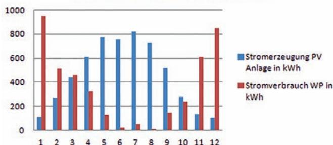
Der gesamte jährliche Energiebedarf betrug 17 MWh. Die Wärmepumpe zieht dazu nur 4,29 MWh Strom aus dem Netz bzw. der PV-Anlage.
